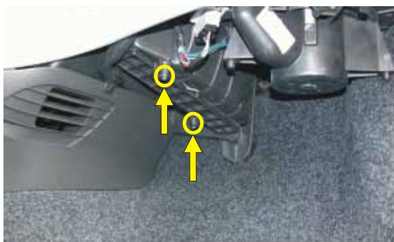
**(PL)** Odkręcić wkręty pokrywy filtra, usunąć pokrywę
